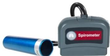
Датчик имеет диапазон измерений от - 320 до + 320 л/мин.
