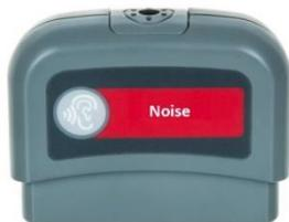
Диапазон измерений датчика: 40 - 110 дБ;
